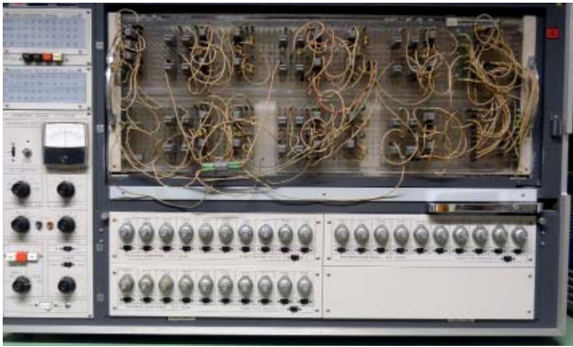
Voorbeeld hoe een analoge computer te programmeren.
