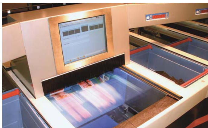
Figuur 1: De wisseling tussen productbakken gebeurt binnen één seconde om duizend keer pakken en neerleggen per uur mogelijk te maken. Het station is beveiligd met lichtgordijnen. Als de operator met zijn handen in de bak zit, dan is er geen beweging.
