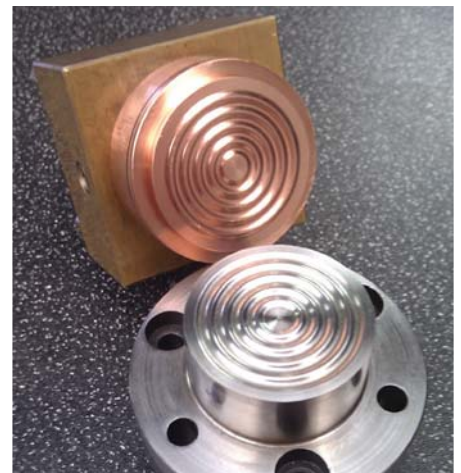
De negatief van de gewenste vorm wordt in het materiaal verzonken.
