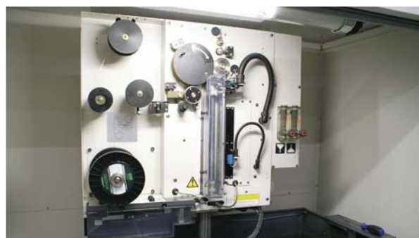
In een zeer preciese opstelling wordt de draad op een optimale spanning gehouden. Zowel mechanisch, als elektrisch.
