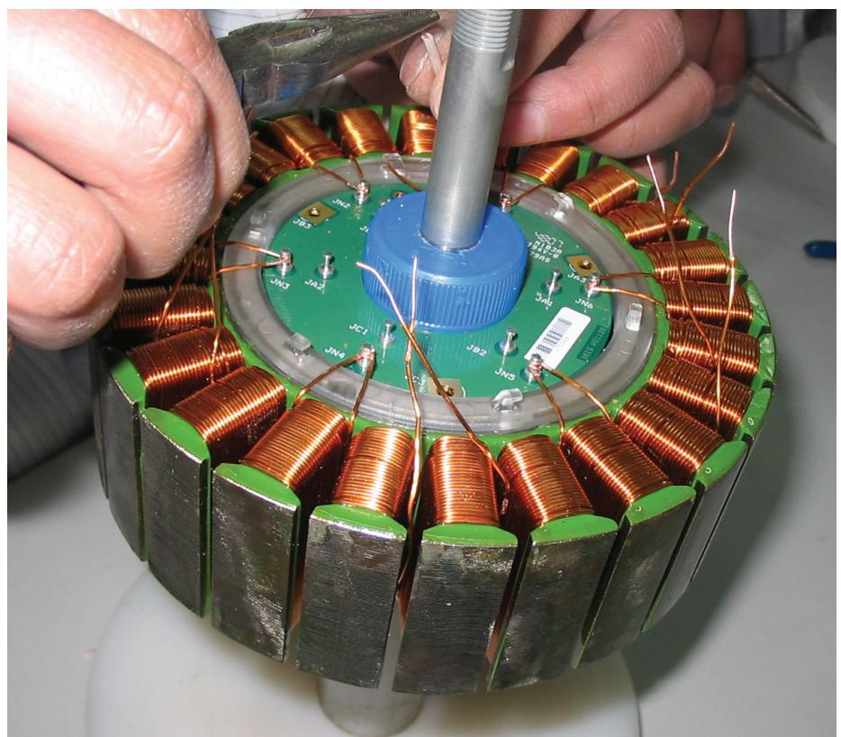
Figuur 3: Handwerk aan de spoeldraden van de motor
