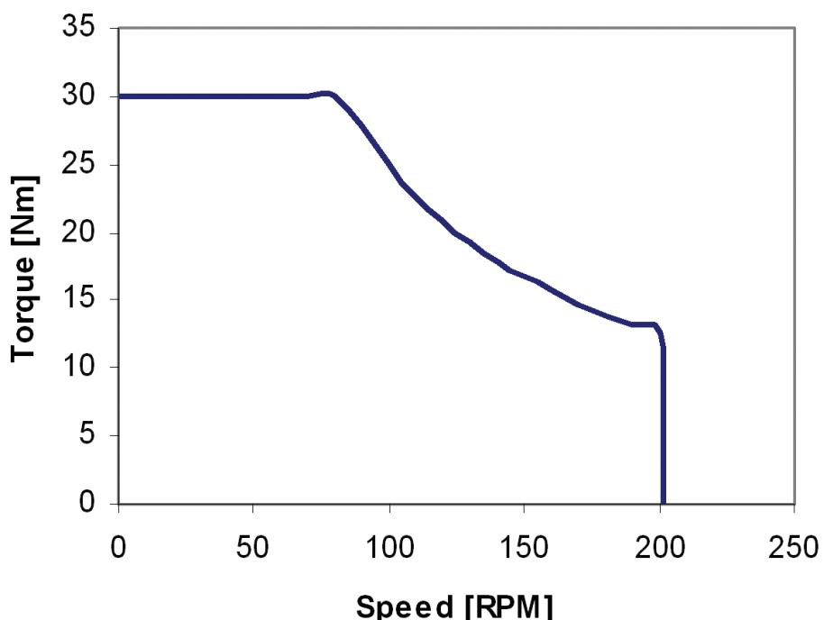
Figuur 1: WT-karakteristiek Accell motor
