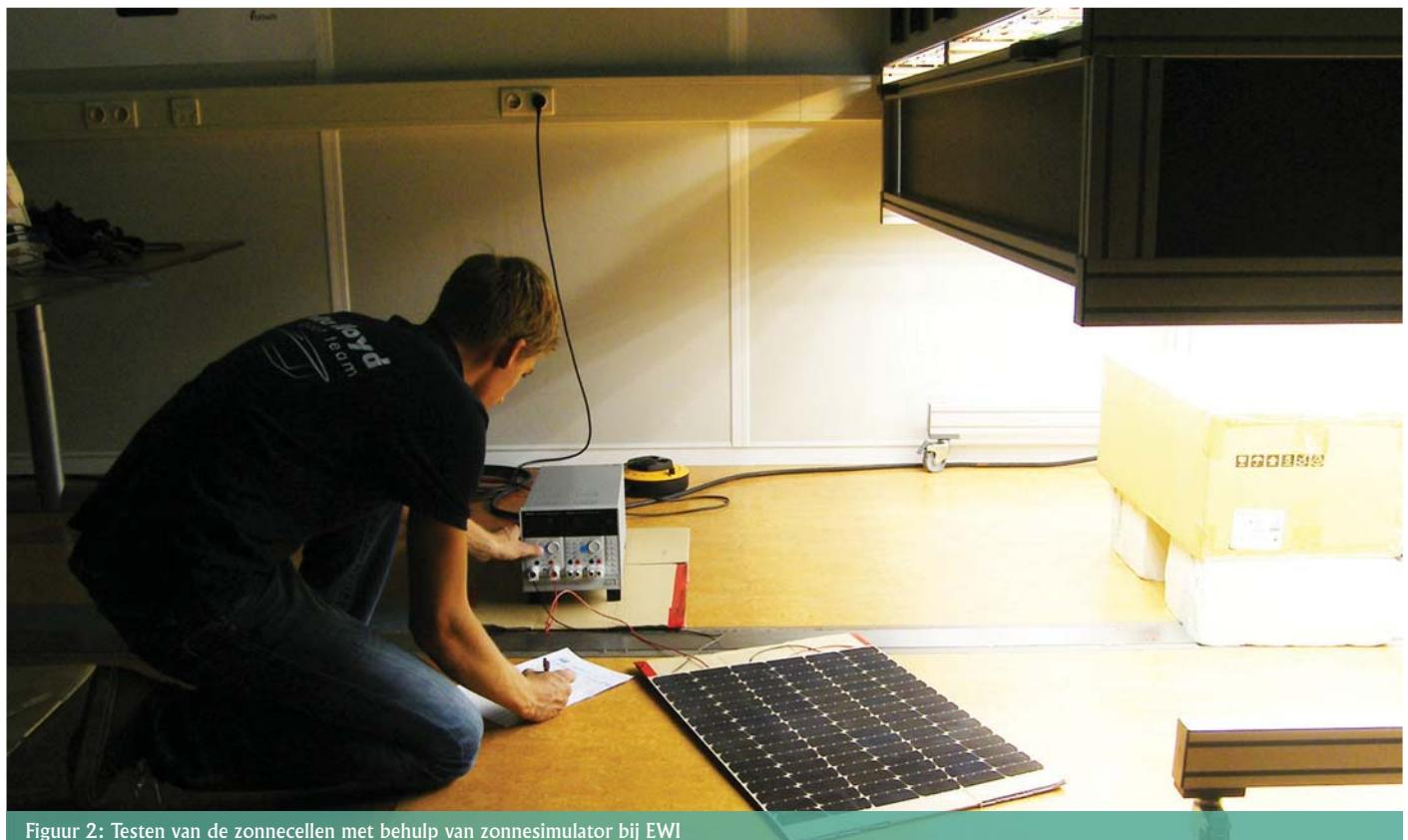
Figuur 2: Testen van de zonnecellen met behulp van zonnesimulator bij EWI
